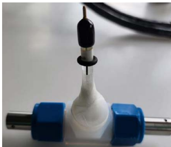
Figure 5 : Une cellule électrochimique de test utilisée au laboratoire pour évaluer les électrodes.
